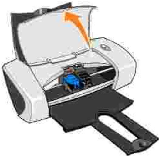
Wenn das Gerät nicht in Betrieb ist, bewegt sich der Druckschlitten in die Ladeposition.
